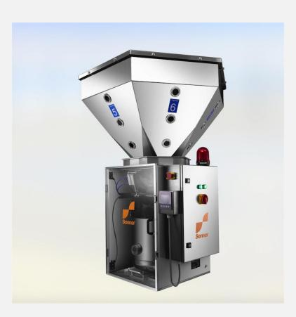
计量工位: 4 - 6 工位 计量精度: <±0.3% 环境温度: 0°C-40°C 环境湿度: ≤80% 防护等级: IP54
